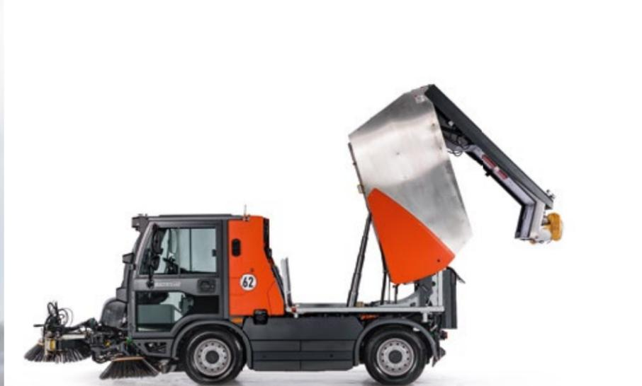
Der glattflächige Edelstahlbehälter lässt sich schnell und gut entleeren und ist besonders leicht zu reinigen.
