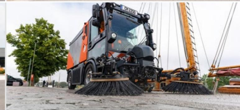
Für zuverlässige und sichere Ergebnisse: Der rollengeführte Saugmund mit Gummidichtleisten steigert die Schmutzaufnahmefähigkeit – und verringert gleichzeitig Anfahrschäden und Verschleiß. Die optionale Saugmundkamera informiert zusätzlich über mögliche Materialanhäufungen.
